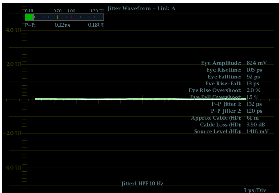
Рис. 26: Параметры джиттера, когда прибор работает в режиме одного экранного окна
