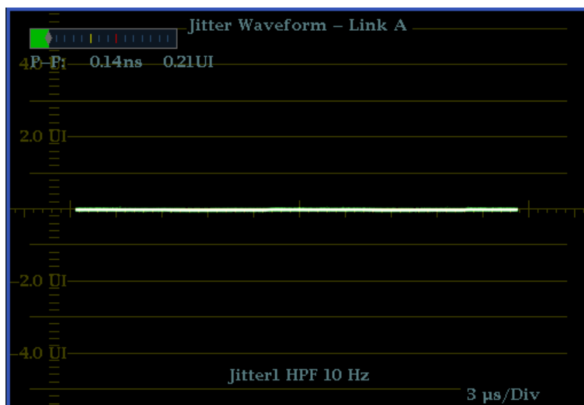
Рис. 25: Параметры джиттера при отображении в одном экранном окне (прибор работает в режиме четырех экранных окон)
