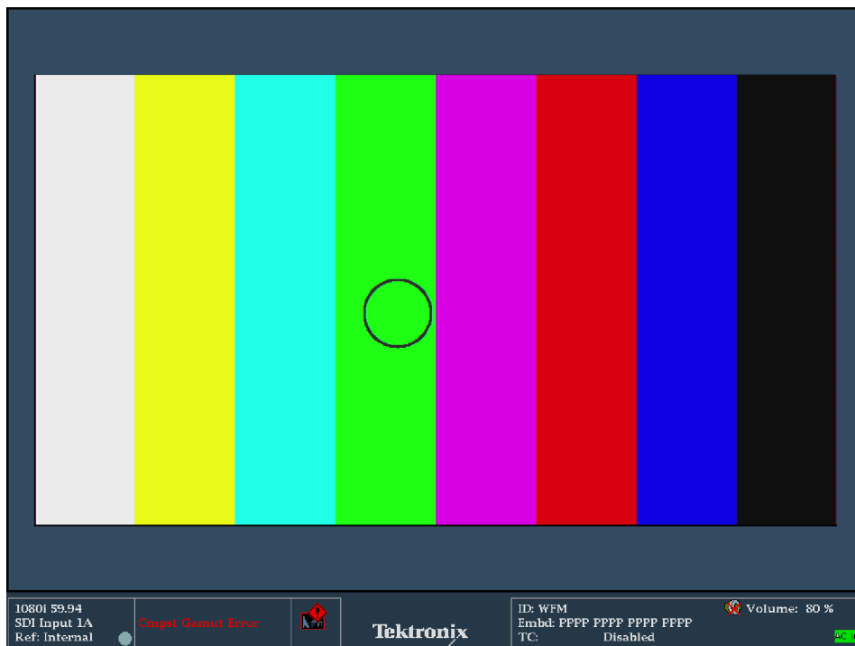
Рис. 24: Экран Picture (картинка), отображающий Moving Circle, включен на выходе SDI
